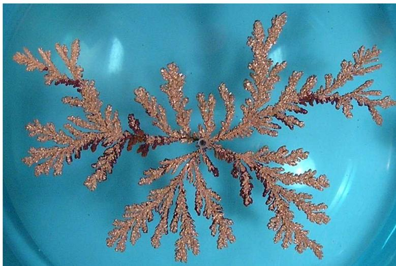
Figura 7: Estrutura de cobre formada a partir de uma solução de sulfato de cobre numa célula de eletrodeposição. Mais informações, [aqui](#).
